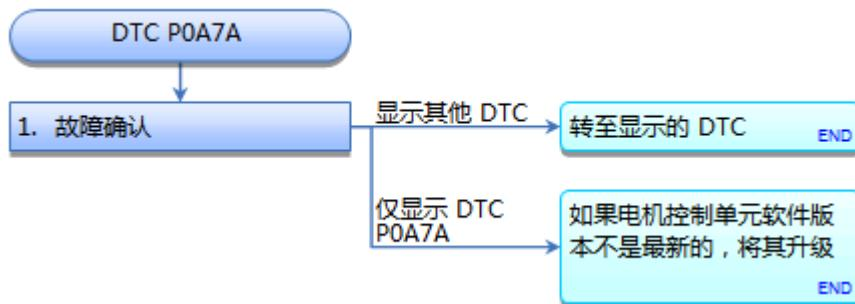
**DTC P0A7A:** 发电机电机逆变器内部电路故障
